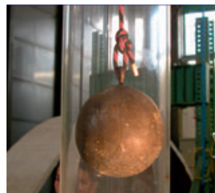
Qui sopra: Percussore sferico in acciaio da 5 kg.
